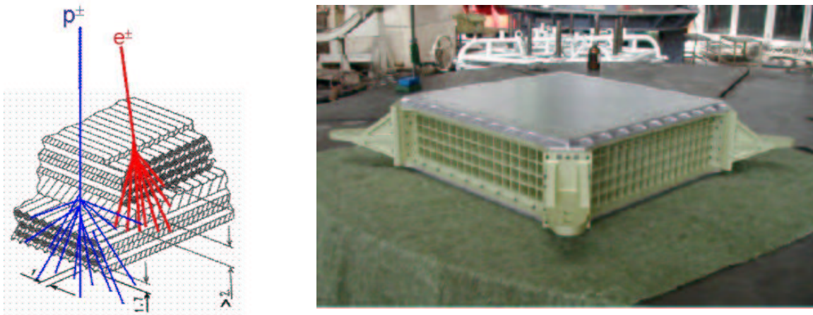
Figura 2.11: Izqda: Estructura de fibras cruzadas del ECAL que permite el muestreo tridimensional de la cascada electromagnética. Dcha: Estructura soporte del ECAL. En las celdas laterales se colocan los fotomultiplicadores.
